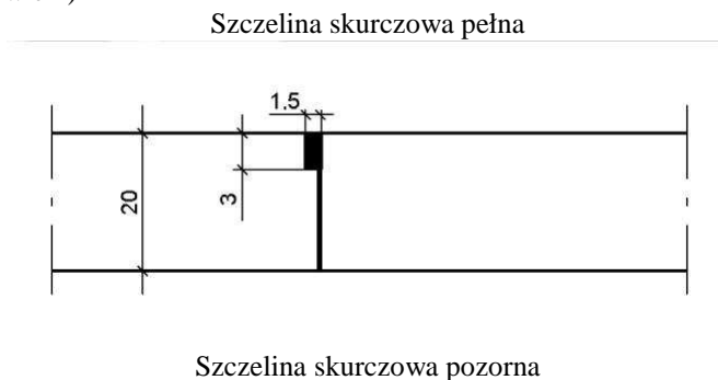
Rys. 1.1. Przykłady konstrukcji szczelin w podbudowie z betonu cementowego (wymiały w cm)
